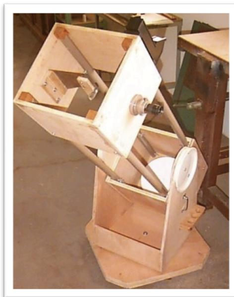
**Figura 5** – Modelo de um telescópio dobsoniano. Visão geral da montagem sem a tampa de proteção da caixa do espelho primário. O espelho encontra-se coberto com papel A4.
