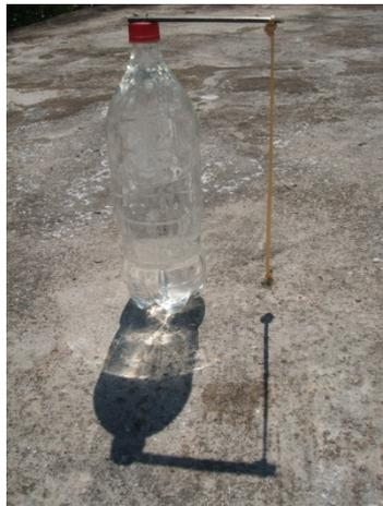
**Figura 10:** Fio de prumo construído para a localização do ponto cardeal Sul.
