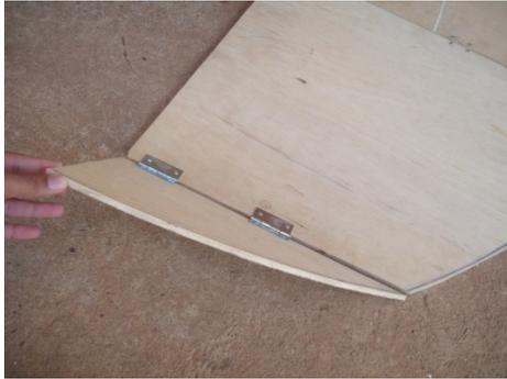
**Figura 17:** Foto das emendas do gabarito do relógio por meio das dobradiças.
